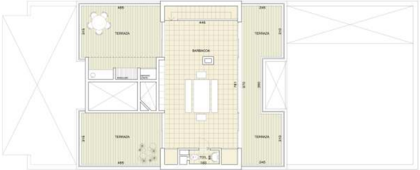
PLANTA BARBACOA escala 1:50 INCLuye PLANTA SUELO PLANO DEL ALC. ADMINISTRACION DE CARNELLI 132.34 m 2 INCLuye AREA TERRAZA 64.48 m 2
